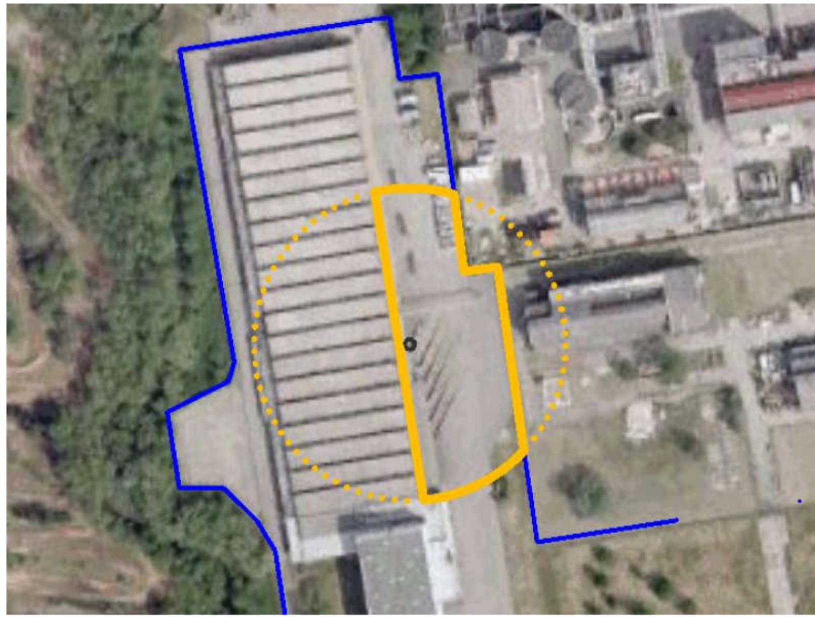
TOP 2a – Estensione delle aree di danno per rilascio all'aperto nella ribalta di scarico di PROTECTOL 50 GA (Glutaraldeide al 50%)
