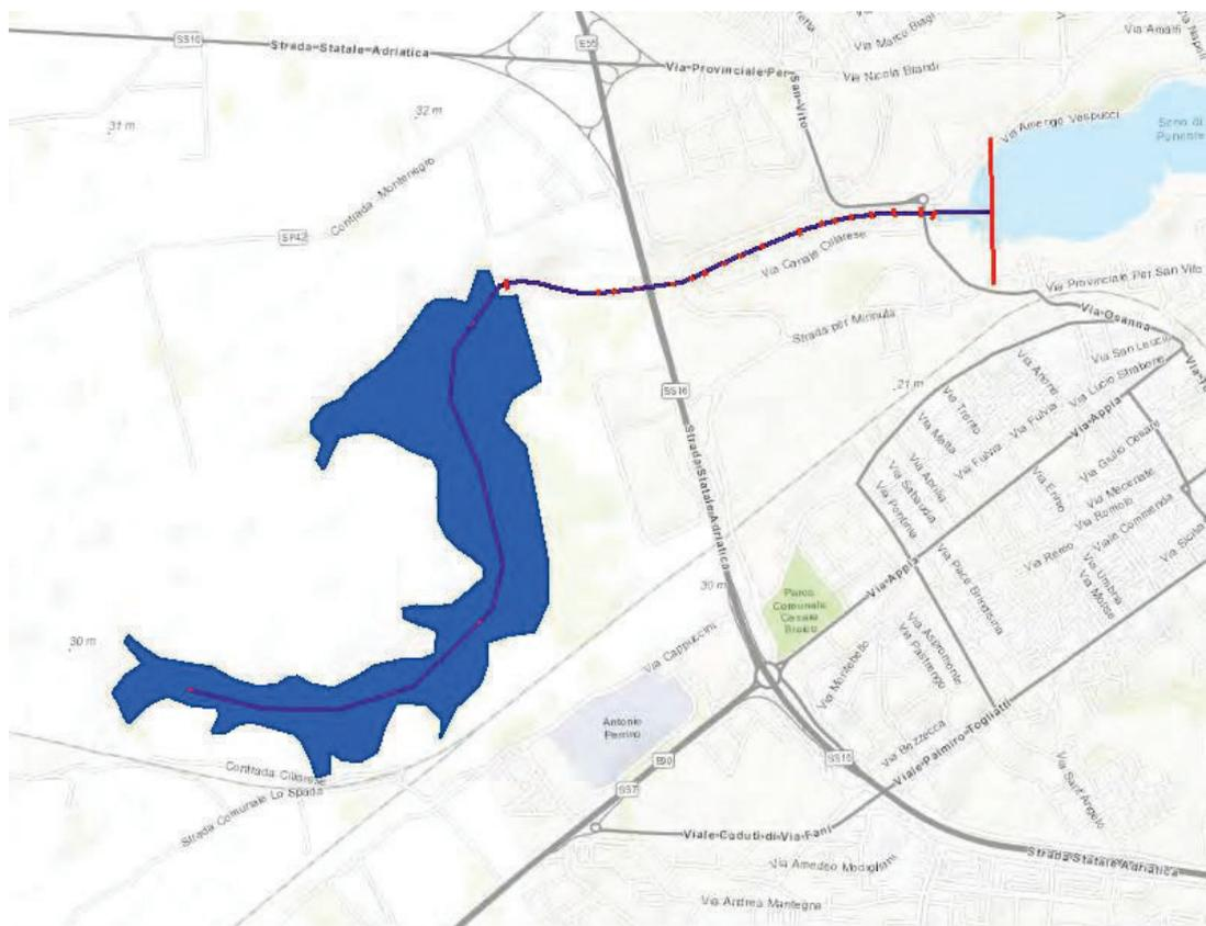
Figura 5-12 Schema del modello idrodinamico con indicazione delle sezioni trasversali di calcolo.
