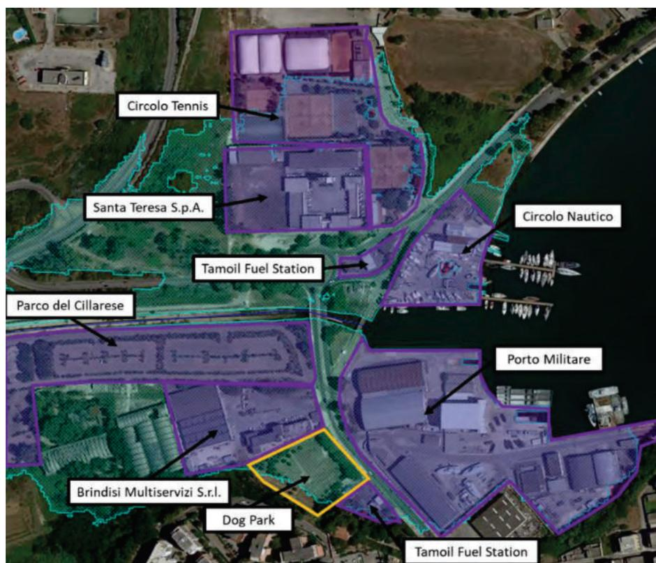
Figura 9-14 Dettaglio degli elementi esposti (in viola D4 e arancione D2) all'interno dell'area di esondazione dello scenario di Dambreak (in ciano) limitrofi allo sbocco del canale Cillarese nel Seno di Ponente del Porto di Brindisi.
