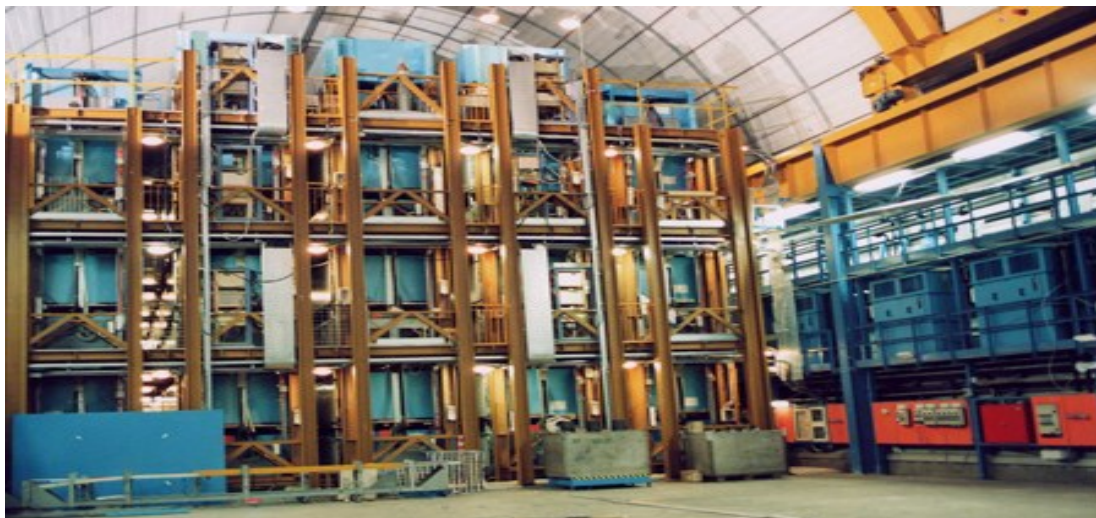
Figura 37 – Esperimento LVD, struttura e tank base
