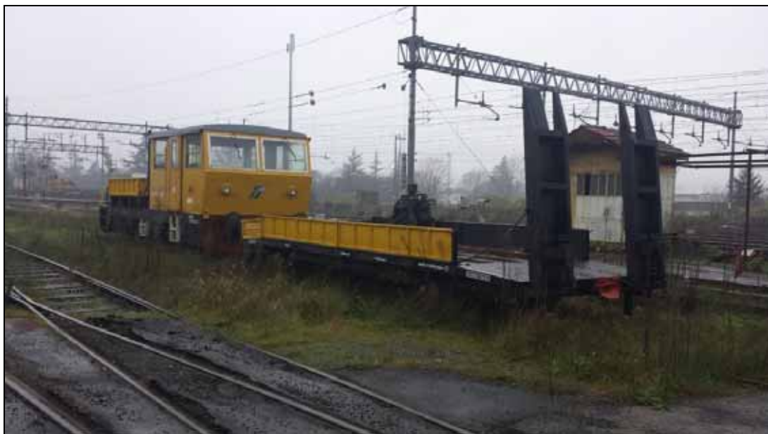
Mezzo d'Opera disponibile presso la stazione di Fornovo (autocarrello M170 + carro pianale)
