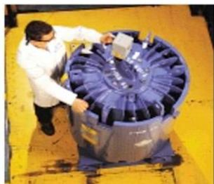
*Imballaggio di tipo B per trasporto sorgenti di  $^{60}\text{Co}$  per impianti di irraggiamento industriale (sterilizzazione di prodotti)*
